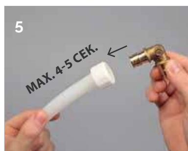
5 Установка фитинга. Перед тем, как труба начнет сжиматься обратно, вставьте фитинг GX внутрь трубопровода до упора.
